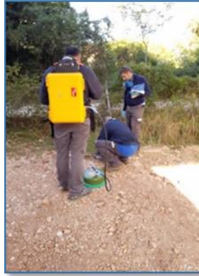
Figura 9 Misure con camera di flusso statica non stazionaria
